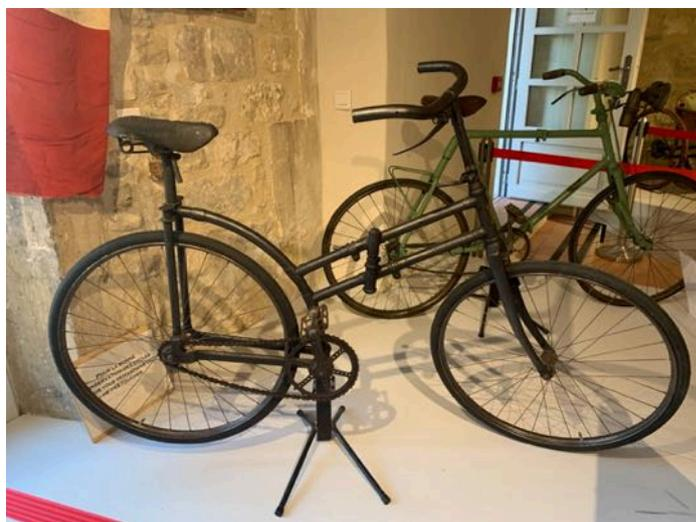
Le plus ancien est un Bianchi de 1909, il équipait l'armée italienne. C'est un vélo pliant avec deux vitesses par retournement de la roue arrière. D'un côté un pignon de 18 dents et de l'autre un pignon de 22 dents. Ce vélo est équipé de suspensions à l'avant et à l'arrière.
