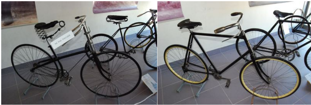
Vélo Peugeot de 1888, à corps droit, avec la chaîne à gauche ou vélo Peugeot de 1899 à transmission par cardan
