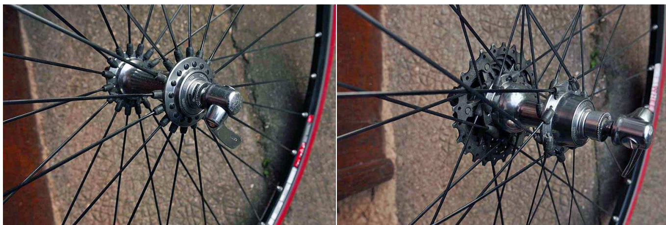
Détails des moyeux avec les pions amortisseurs
