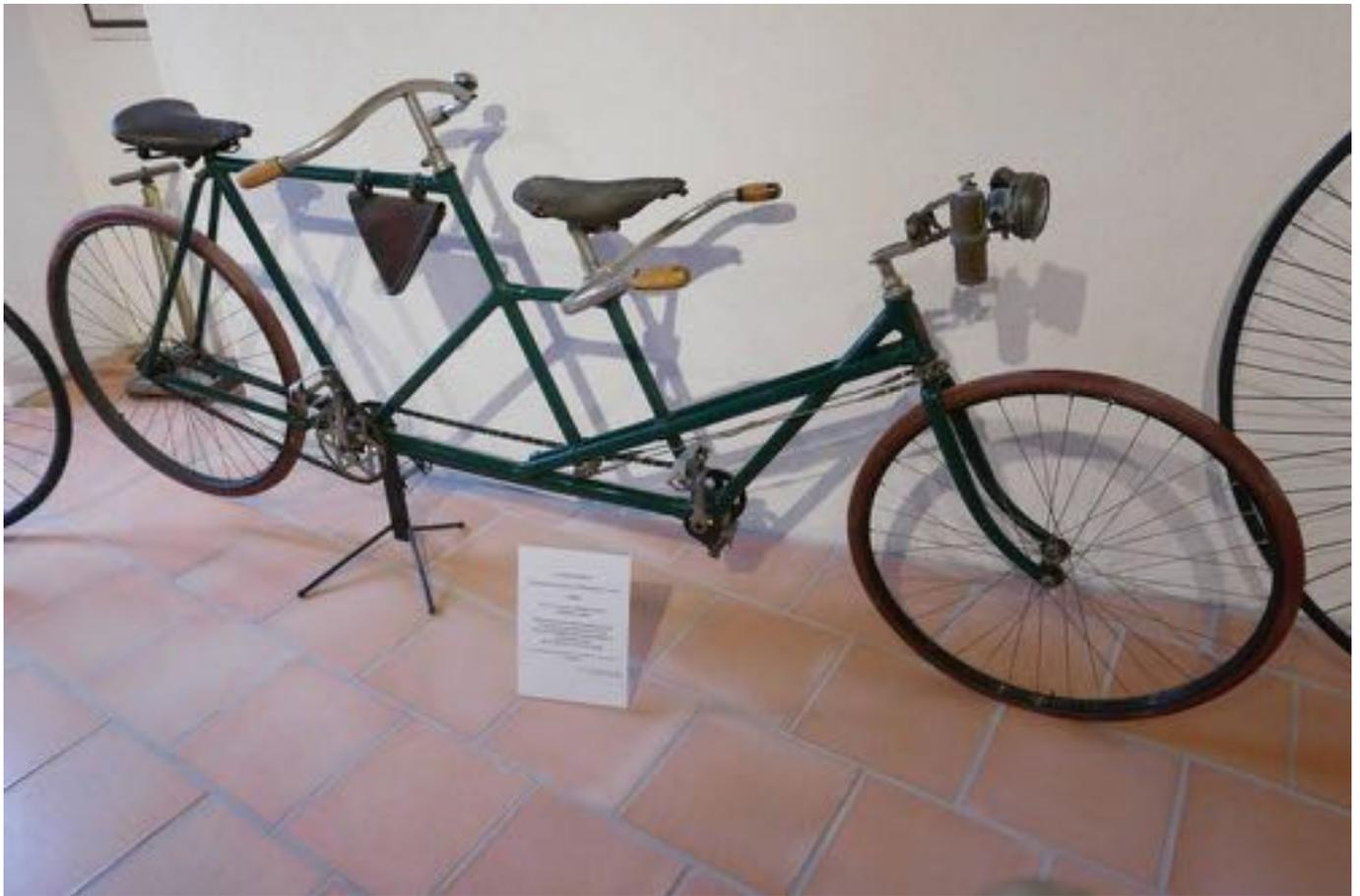
Bien sûr les tandems sont aussi bien représentés et on remarque ce modèle mixte construit en 1899 par Cottereau à Dijon. Le pilote est à l'arrière et la direction est renvoyée sur la roue avant par pignon, chaîne et câbles.
