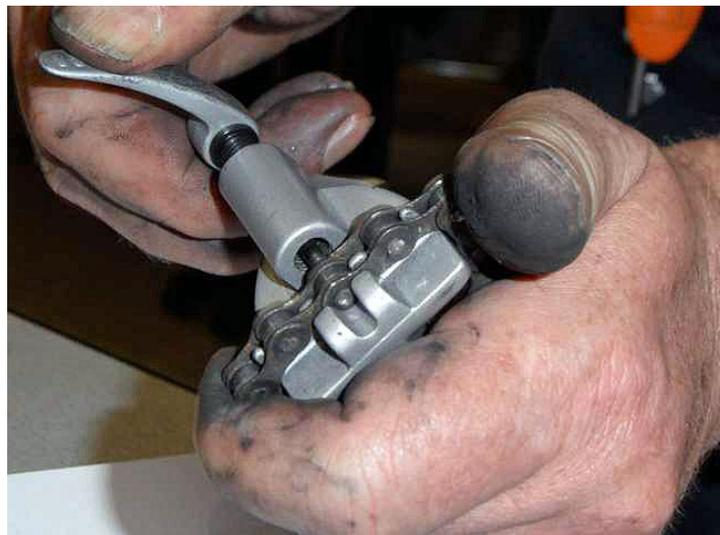
Les anciens ont du métier, et ils nous ont fait partager dans la bonne humeur, les ficelles de la débrouille : gardez vos vieux rayons de roues pour les réutiliser comme crochet à maintenir la chaîne lors de l'utilisation du dérive chaîne ou encore à fabriquer, après une mise en forme, une vrille pour réalésier les gaines des câbles. D'ailleurs, une ABEILLE m'a appris que les rayons pouvaient faire office de brochettes. Si vous avez des astuces de ce genre, je vous propose de les faire partager.
