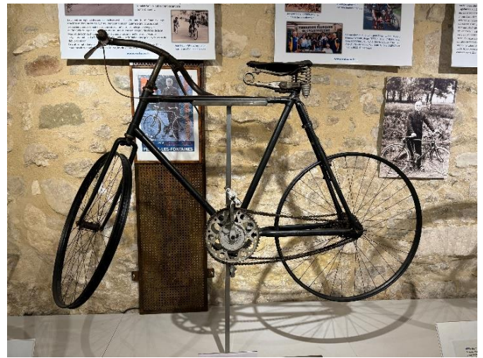
Bicyclette Bi-chaîne de 1902 La Gauloise, Constructeur Paul de Vivie de Saint-Etienne 3 vitesses avec plateau débrayable
