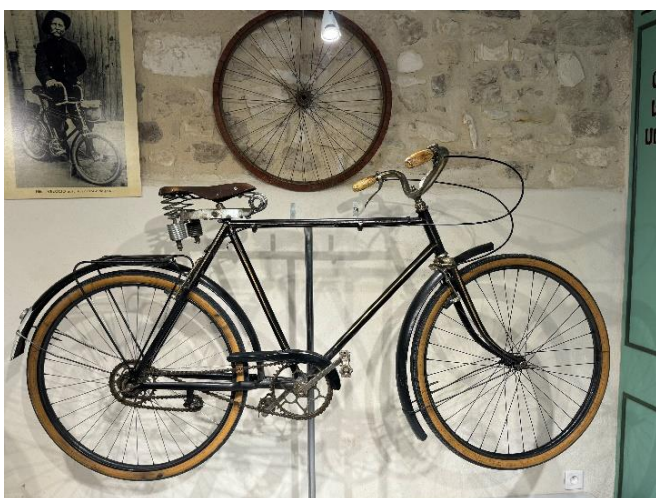
Bicyclette Homme « Hirondelle » de 1925 Manufactures d'Armes et de Cycles de Saint-Etienne Deux vitesses avec le système dit « retro-directe » Grand développement en pédalant dans le sens habituel et petit développement en pédalant en arrière. Changement de vitesse instantané sans autre opération que le changement de sens de rotation du pédalier.
