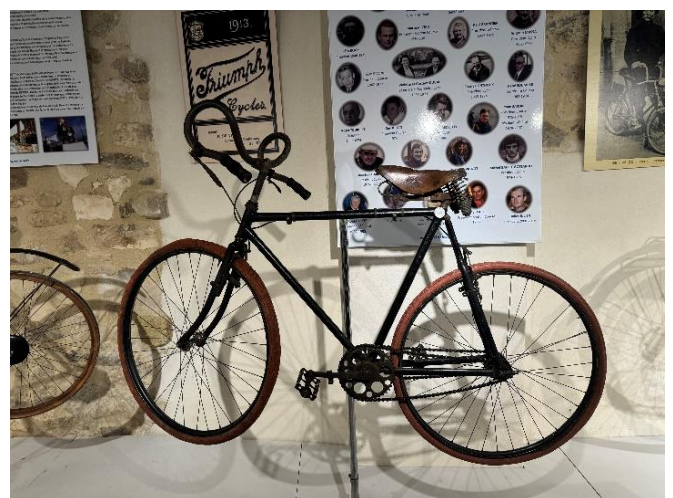
Bicyclette de 1922 La Gauloise Constructeur Paul de Vivie de Saint-Etienne Bi-chaîne et 3 plateaux Guidon à deux points d'appui, inventé par Vélocio qui l'appelait « de lutte contre le vent », préfigure le guidon des futurs vélos de contre la montre.
