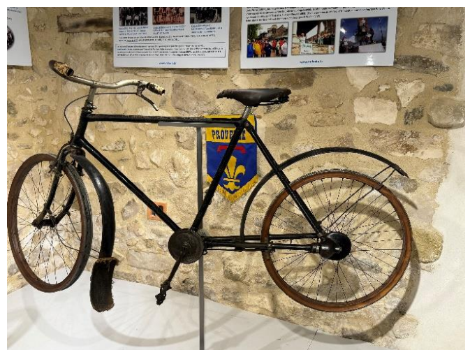
Touricyclette de 1905 Modèle Acatène du constructeur Magnat Debon de Grenoble Transmission par arbre et couple conique Deux vitesses avec repédalage
