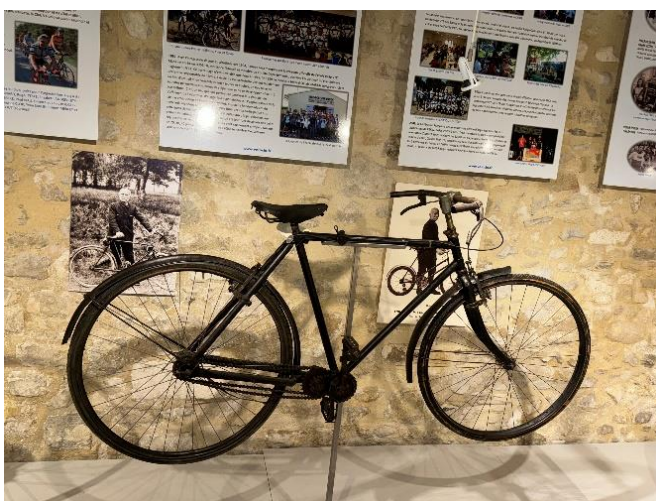
Polycyclette La Gauloise de 1903 Constructeur Paul de Vivie de Saint-Etienne 3 vitesses avec deux chaînes et un axe intermédiaire derrière la boîte de pédalier avec pignon débrayable
