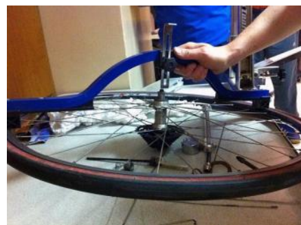
3e outil pour vérifier le voilage dit le parapluie.
