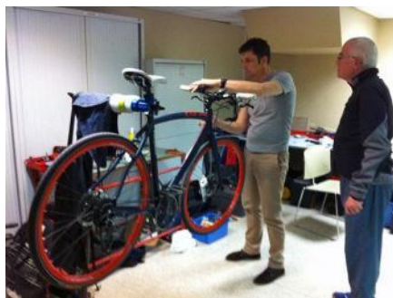
Régler la course de manette de frein hydraulique.
