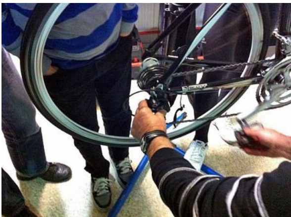
Réglage des butées haute et basse
