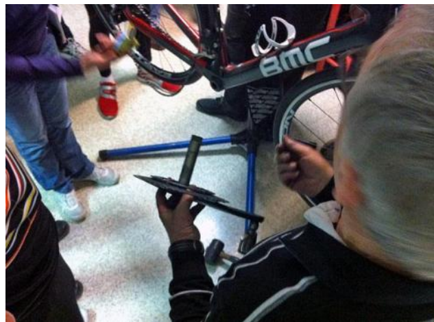
Vélo récent avec axe + plateaux + manivelle = 1 seule pièce recouverte de résine
