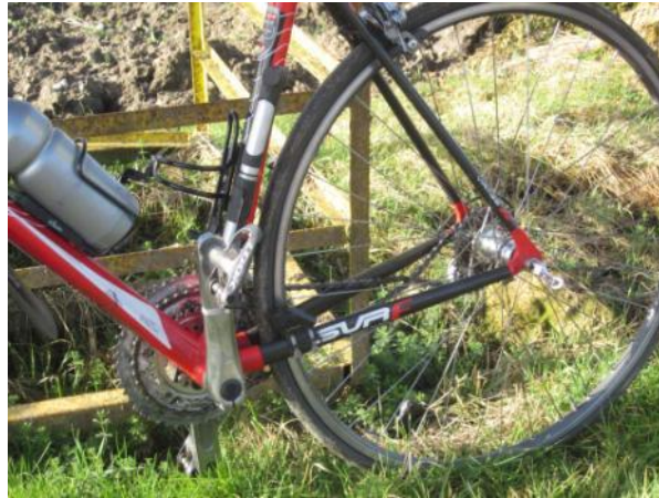
Après une crevaison un ancien élève des stages de mécanique du CODEP92 remonte sa roue. Pédale-t-il à l'envers ou bien y a-t-il un défaut dans le passage de la chaîne autour de la roue libre ? Voilà un stagiaire qui pourrait redoubler l'initiation à la mécanique !
