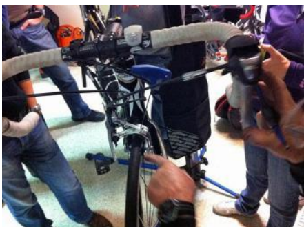
Régler le même débattement à droite et à gauche
